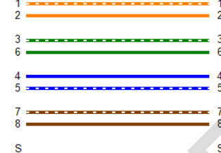
Схема разводки (T568B)
